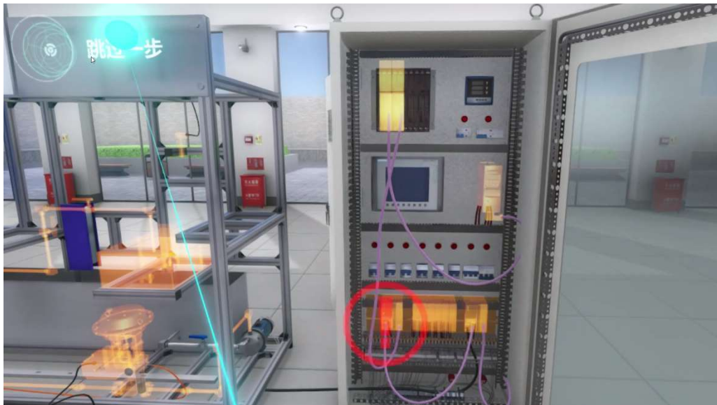
八、启动开关和按钮，有直启泵和变频泵手动、自动开关；各个仪表的开关以及急停按钮
